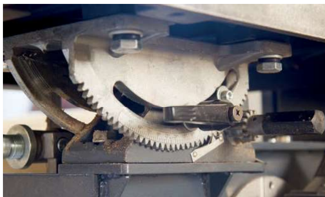
Il bullone regolabile posizionato al di sotto del piano serve a riposizionare con rapidità il piano sullo 0^{\circ} . Va regolato in proprio e bloccato con l'apposito dado.
